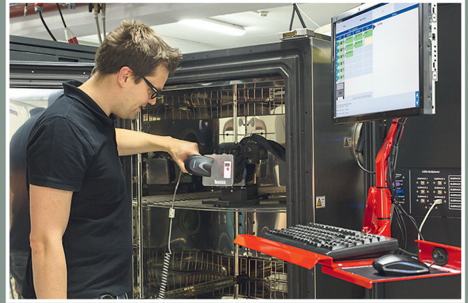
Durch das Scannen eines Barcodes an Prüfling und Kabelbaum sowie an Kabelbaum und Subrack wird sichergestellt, dass die Messkanäle richtig zugeordnet werden. Fehler sind so nahezu ausgeschlossen.
